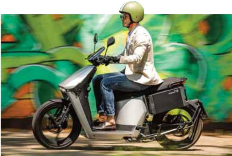
El nuevo scooter eléctrico WoW 775 tiene un diseño actual y sencillo, con el motor central y las baterías que se alojan en dos compartimentos laterales.
